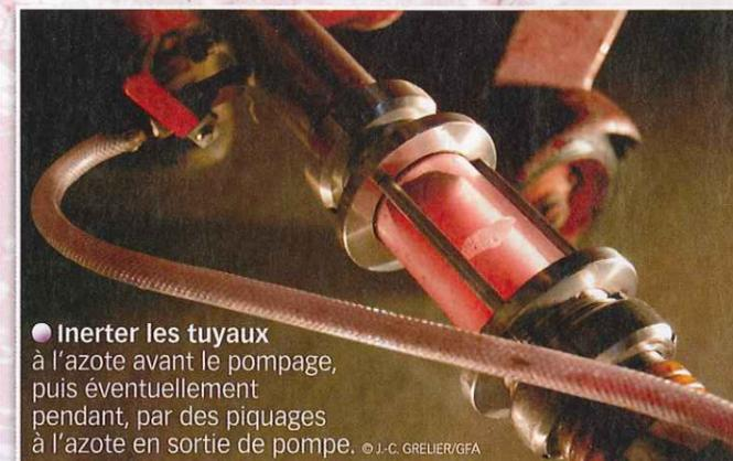
Inerté les tuyaux à l'azote avant le pompage, puis éventuellement pendant, par des piquages à l'azote en sortie de pompe.
