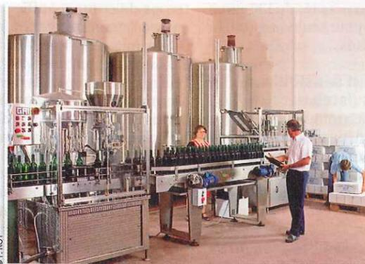
Utiliser des tuyaux les plus courts possible. Dans ce but, placer le matériel de tirage ou la pompe d'aspiration au plus près de la cuve initiale.
