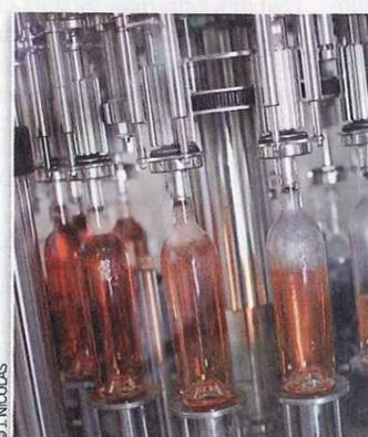
Opter pour une tireuse qui inerté les bouteilles à l'azote avant tirage, ou qui remplit par dépression.
